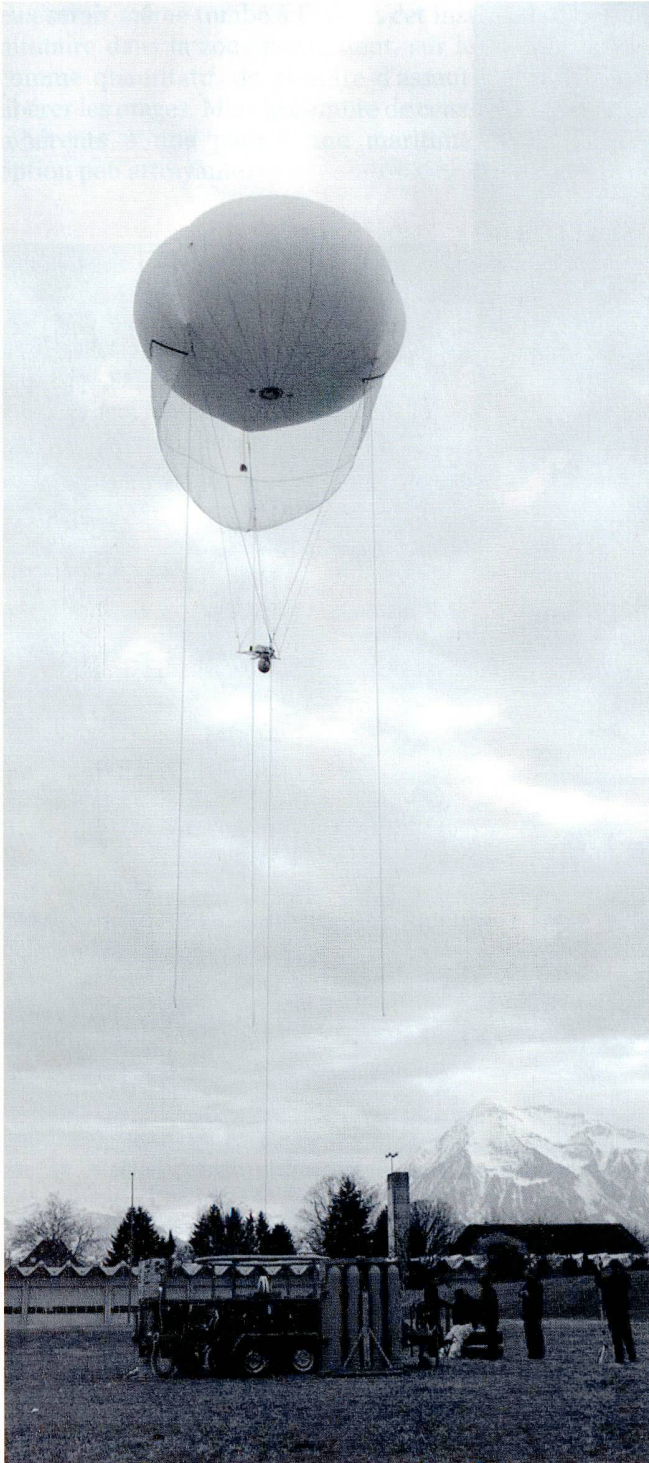
L'utilisation de ballons captifs chargés de caméras permet l'observation jusqu'à des distances pouvant aller jusqu'à 65 km.
