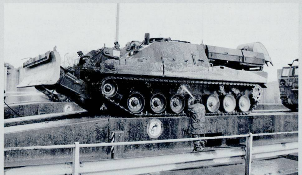
Le char du Génie est en mesure de déblayer tous types d'obstacles sous la protection d'un blindage.
