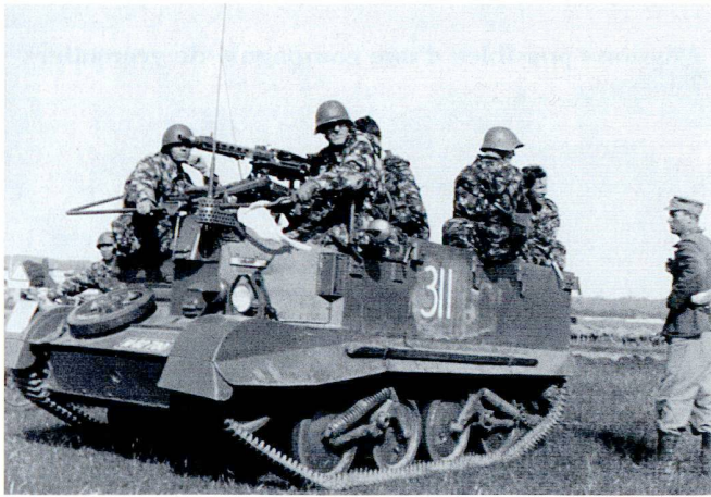
L' Universal Carrier est un engin acquis en Grande-Bretagne 1960. Chenillé et rapide, il lui manque cependant toujours une protection adéquate.
