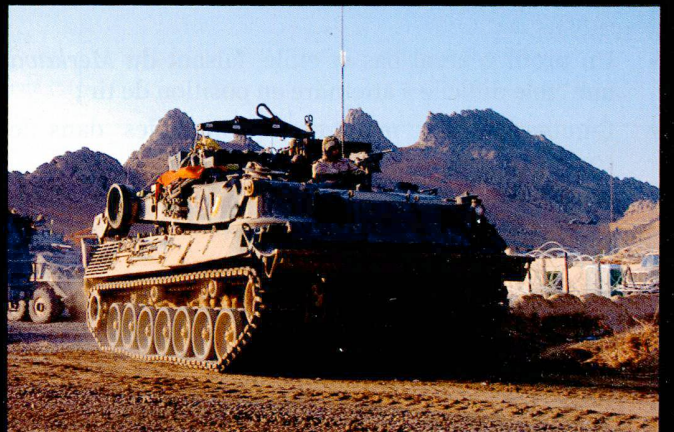
Le Badger est un engin du génie construit sur le châssis du Léopard 1.
