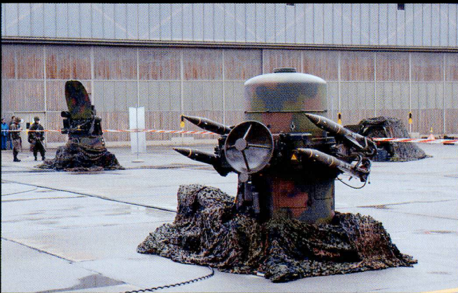
Le système se compose de lanceurs à 4 engins équipés d'un radar de surveillance et de suivi.
