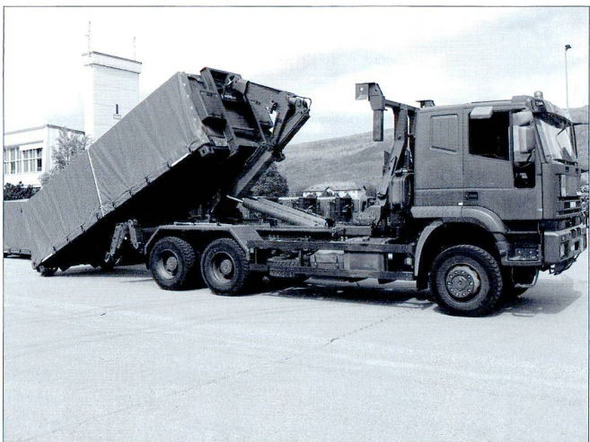
Le camion décharge le « flat ».
