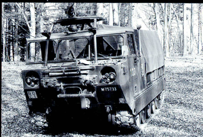
Le ravitaillement en munitions se fait par chenillettes M-548 ou par camions.
