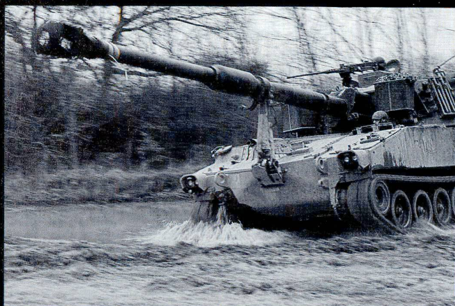
L'obusier blindé M-109 est équipé d'un système de navigation inertielle (NAPOS).
