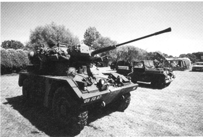
Le Fox est un engin léger 4x4 armé d'un canon Rarden de 30 mm.
