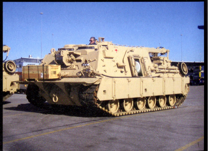
Les insuffisances du M88 (56 t) ont conduit au développement du M88A2 Hercules (70 t), afin de permettre le tractage d'un M1A1
