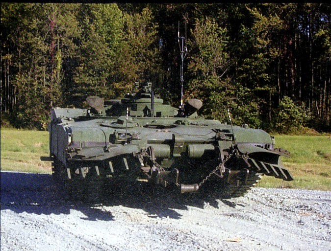
Le M1 Panther II est un engin de déminage télécommandé, également sur châssis Abrams .
