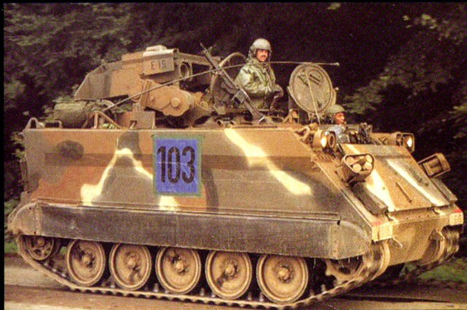
M901 ITOW équipé d'une tourelle escamotable portant deux missiles TOW.
