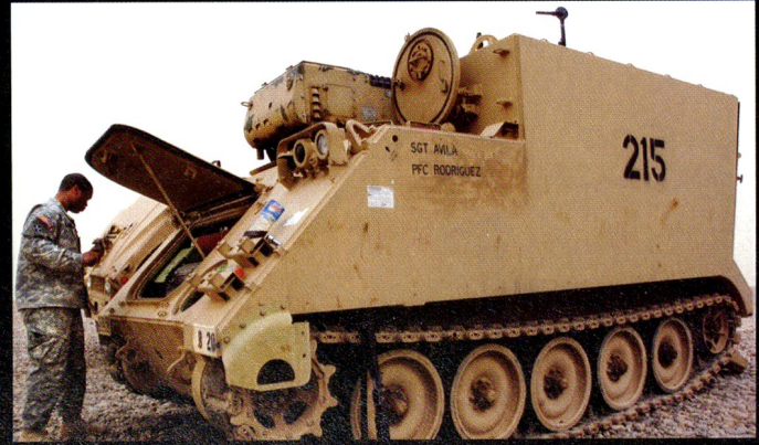
M577A1 de commandement, au compartiment arrière surélevé.
