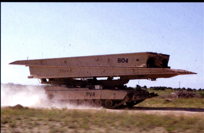
Le M104 Wolverine est un pont d'assaut destiné à remplacer l'AVLB.
