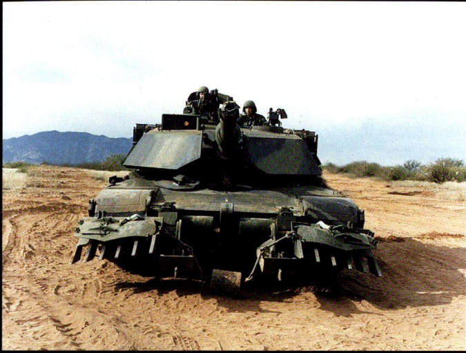
A l'engagement, un char par section est équipé d'une charrue anti-mines (Clearing Blade System); ces 4 véhicules sont parfois regroupés en une seule section.
