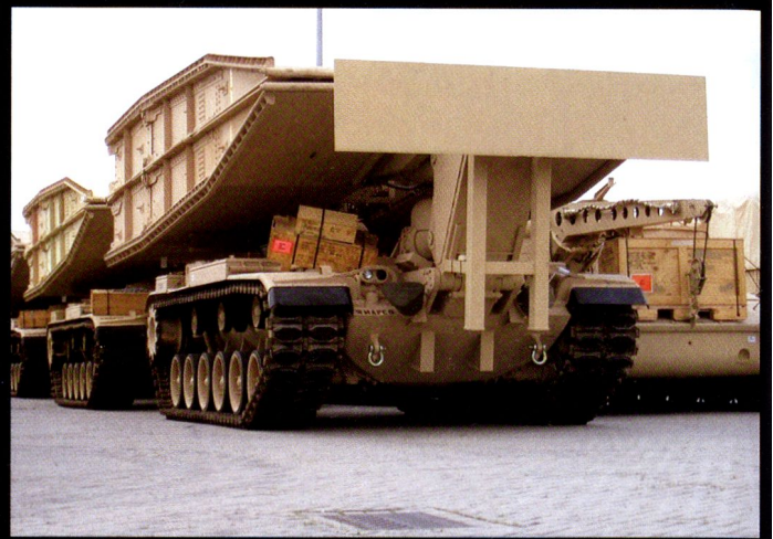
L'AVLB porte un pont ciseaux de 19 mètres.
