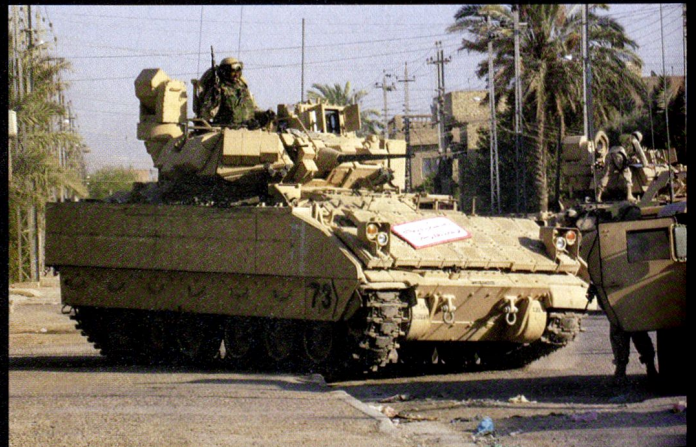
Le M2A3 dispose d'une optronique et d'une conduite de tir jour/nuit stabilisées à l'arrière de la tourelle.
