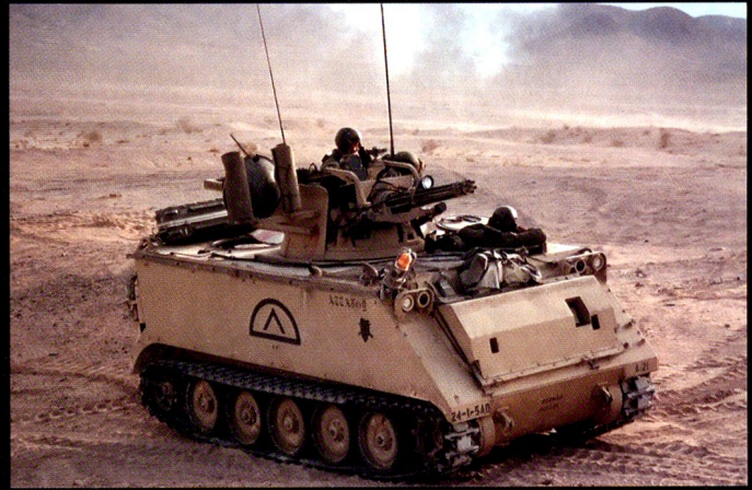
Le M163 Vulcan est une version DCA équipée d'un canon M61 de 20 mm.
