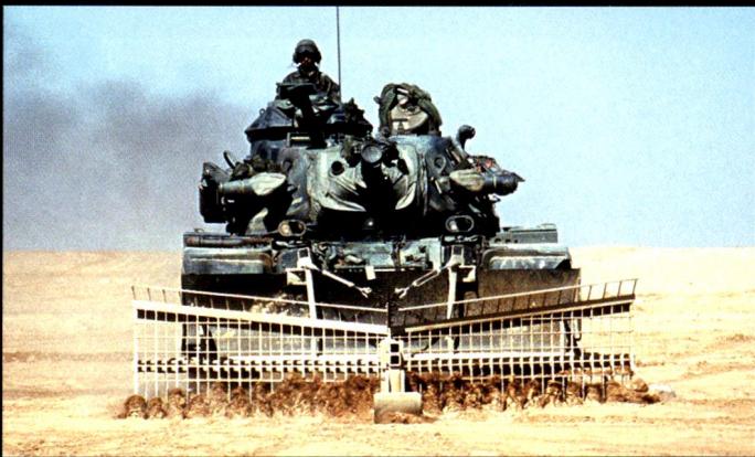
Le M728A1 est un M60 destiné au Génie, équipé d'une lame anti-mines et d'un canon de 165 mm.
