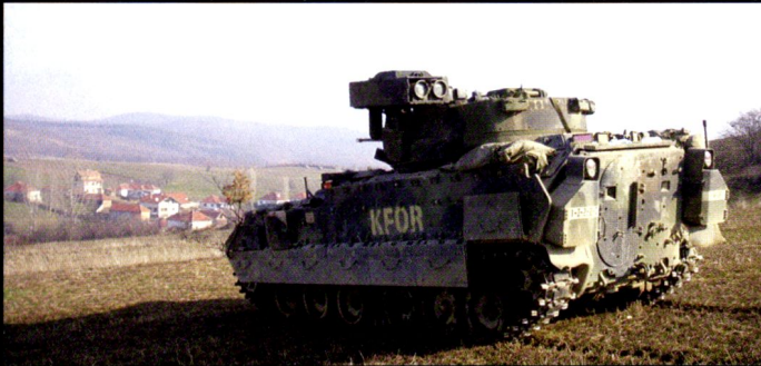
M2A2 en Bosnie, avec son lanceur TOWII déployé. Il dispose d'un moteur plus puissant (600 PS).
