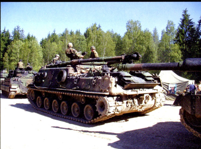
Le M88A1 est le char de dépannage conçu sur le châssis du M60.
