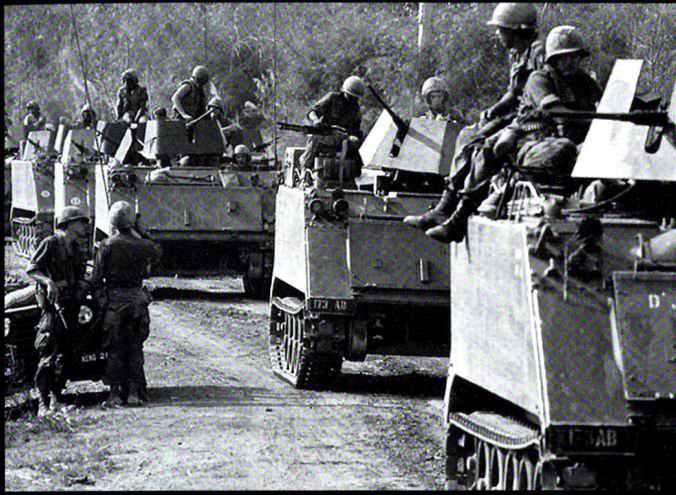
M113 équipé du kit ACAV (Armored Cavalry Assault Vehicle) au Vietnam.
