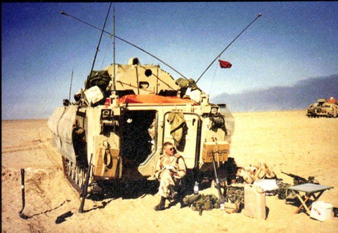
Le M981A3 FISTV emmène les commandants de tir de l'artillerie et est équipé de 4 radios SINCGARS. Il emporte un officier, un sous-officier et deux soldats.
