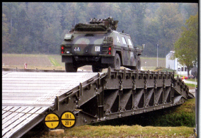
Le pont fixe 69 est lent à mettre en œuvre et nécessite une main d'œuvre importante ; sa longueur peut aller jusqu'à 48 mètres. En raison de son âge, le pont fixe 69 n'est utilisé aujourd'hui qu'avec de nombreuses servitudes : 29,33 mètres et 28 tonnes de charge au maximum.
