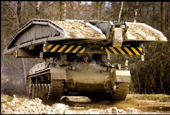
Le char poseur de ponts est conçu à partir du châssis du char 68. Il peut poser un pont de 18 mètres.
