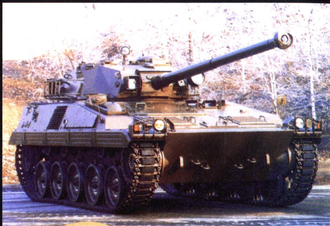
Le MARS 15 était une tentative française de disposer d'un châssis commun de VTT et de char léger dans les années 1980.
