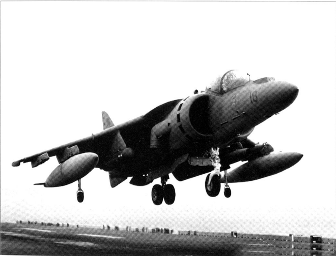
AV-8B+ de l'USMC. On remarque le nez «gonflé» afin d'emporter le radar APG-65.
