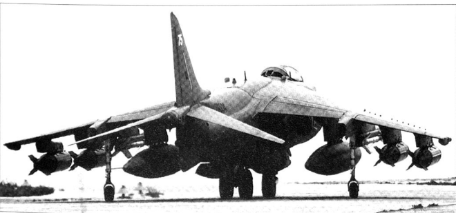
Harrier GR 7 en Italie, armé de 4 bombes à sous-munitions BL755, destinées à appuyer l'intervention de l'OTAN en Bosnie, 1995.
