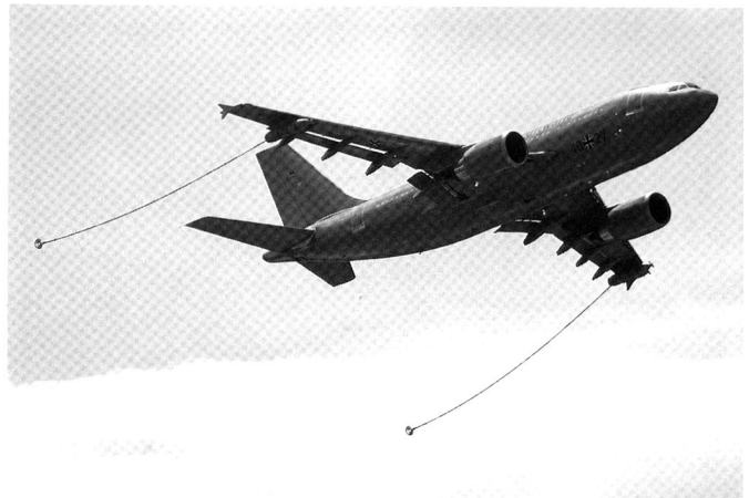
L'A310 MRTT disposant de deux «drogue» plus polyvalents; un point de ravitaillement rigide, central, est actuellement en train d'être ajouté.
