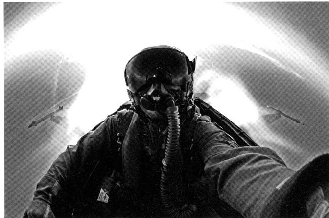
Les accélérations puissantes durant les manœuvres de combat aérien génèrent la condensation de l'air marin humide sur le dos du Hornet .
