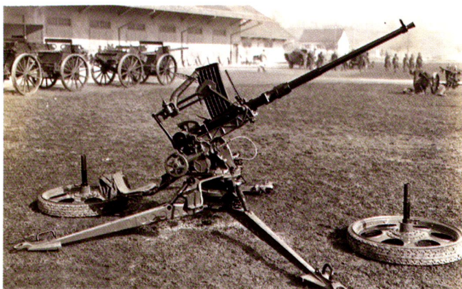
Le canon DCA 20mm 37 Oerlikon, à disposition des troupes lors de la mobilisation.
