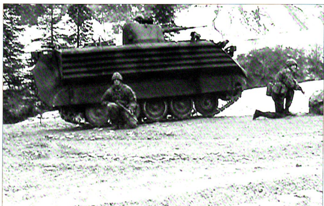
Le Char 63/73/89 est armé d'un canon de 20 mm HS48. Cp gren chars IV/17, Wichlenalp, 2002.
