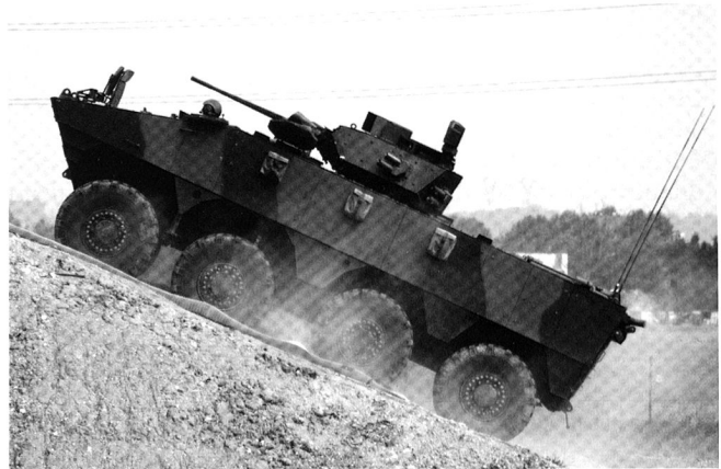
Le VBCI dans sa version de combat d'infanterie, équipé d'une tourelle de 25 mm.
