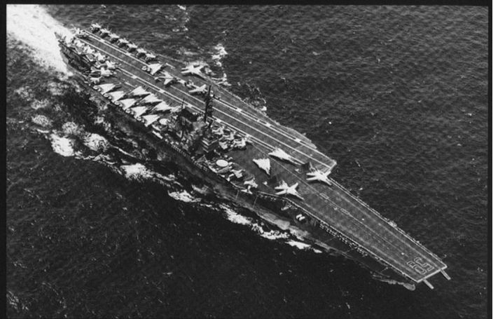
L'USS Forrestal est le premier «superportavion», en raison de sa taille immense et de son système de catapultes et de monte-charges.
