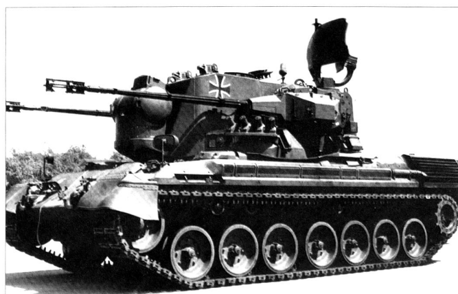
Le char de DCA Gepard , en service dans la Bundeswehr, armé de deux canons de 35 mm Oerlikon.
