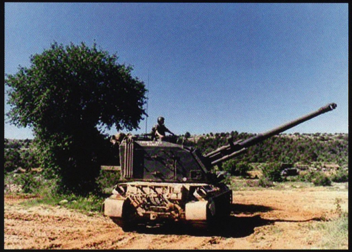
Le 155 GCT français est conçu sur châssis du char de combat AMX-30. Il a notamment été déployé en Bosnie Herzégovine et plus récemment au Liban sous les couleurs de l'ONU.
