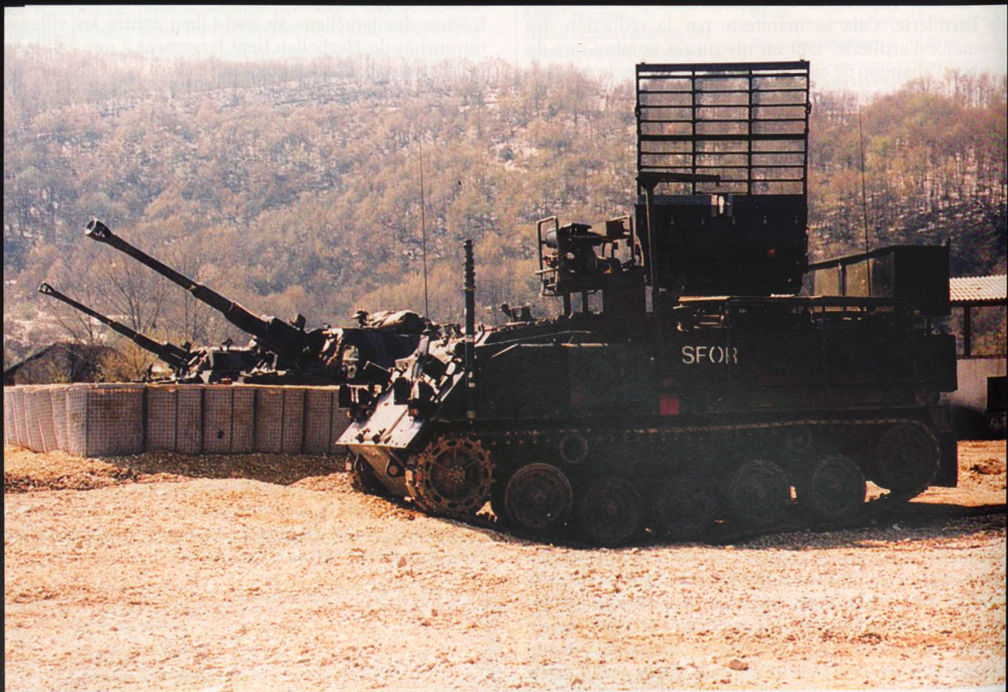
Les radars d'artillerie se sont multipliés depuis les années 1970. Ils servent essentiellement à la détection de mouvements mécanisés et aux calculs pour les tirs de contre-batterie. Aujourd'hui, ces systèmes sont en grande partie remplacés par des radars aériens.
