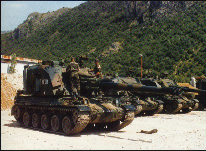
Le 155 GCT français est conçu sur châssis du char de combat AMX-30. Il a notamment été déployé en Bosnie Herzégovine et plus récemment au Liban sous les couleurs de l'ONU.
