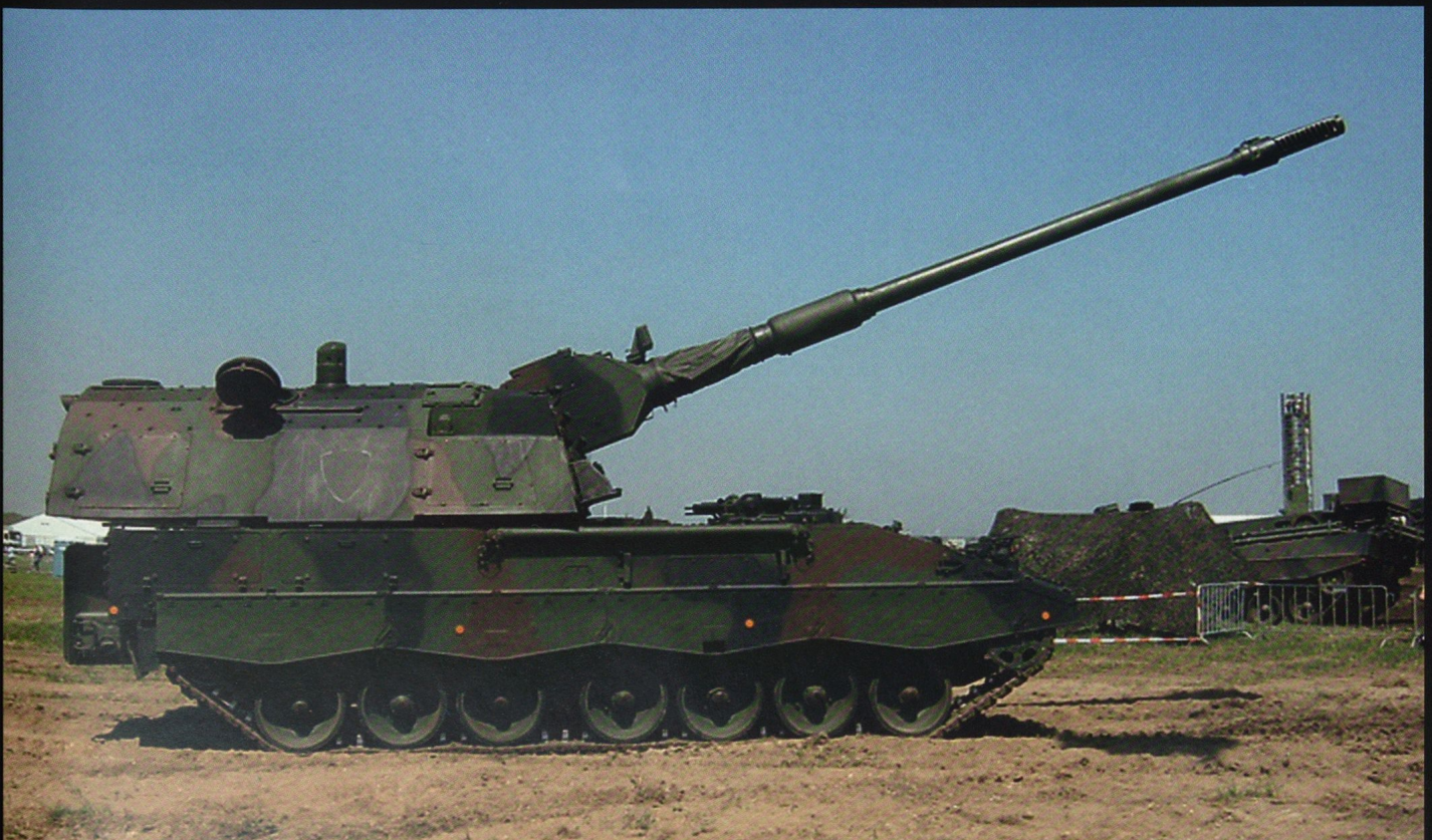
Le Panzerhaubitze 2000, sur châssis Léopard 2 . Il s'agit actuellement du système le mieux protégé et disposant de la puissance de feu la plus élevée. Il est hautement automatisé et a été déployé en Afghanistan par les Pays-Bas.
