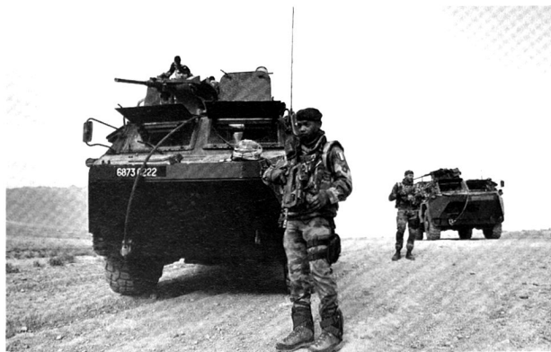
Le Véhicule de l'avant blindé (VAB) a été récemment équipé de surblindages et d'une tourelle télé-opérée de 12,7 mm.
