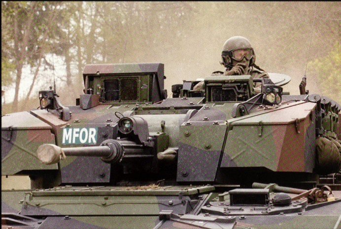
L'ASCOD est équipé d'un canon Mauser de 30 mm et d'un système de conduite de tir Kollmann. Il emporte 3 hommes d'équipage et 8 grenadiers de chars, pour une masse d'environ 28 tonnes.
