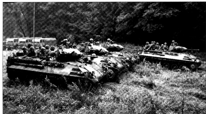
Malgré ses qualités, l'armement -un canon Oerlikon de 20 mm-, l'équipement et la protection sont aujourd'hui obsolètes.
