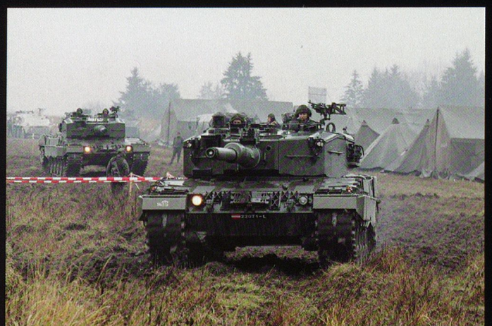
On remarque que les lance-pots nébulogènes néerlandais ont été modifiés, mais selon une disposition différente du système 4+4 allemand et helvétique. Les mitrailleuses FN de 7,62 mm ont cependant été conservées.
