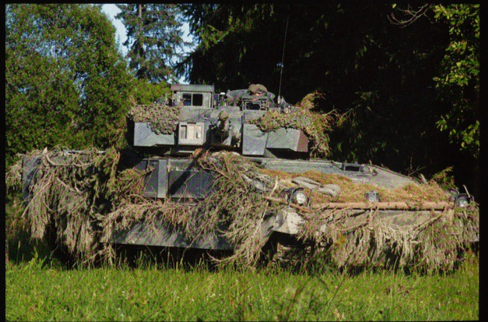
L'ASCOD est équipé d'un canon Mauser de 30 mm et d'un système de conduite de tir Kollmann. Il emporte 3 hommes d'équipage et 8 grenadiers de chars, pour une masse d'environ 28 tonnes.
