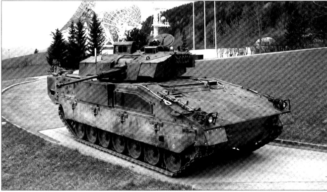
L'Ulan pèse 28 tonnes, roule à 72 km/h et possède un moteur diesel de 720 PS.
