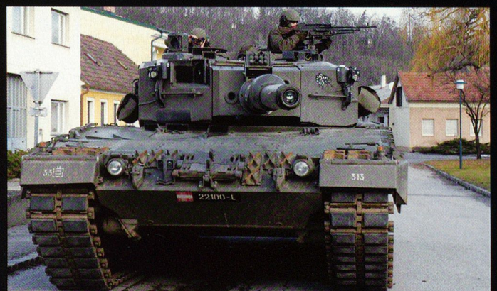
On remarque que les lance-pots nébulogènes néerlandais ont été modifiés, mais selon une disposition différente du système 4+4 allemand et helvétique. Les mitrailleuses FN de 7,62 mm ont cependant été conservées.
