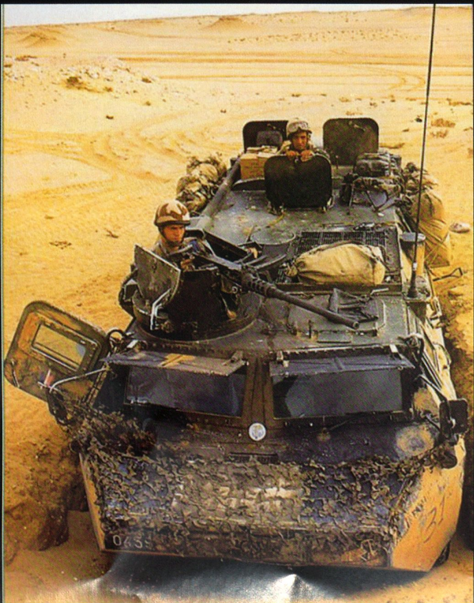
Un poste d'observation est installé avant l'engagement d'une patrouille de reconnaissance. Les VAB des chefs de pelotons sont armés d'une mitrailleuse de 12,7 mm.
