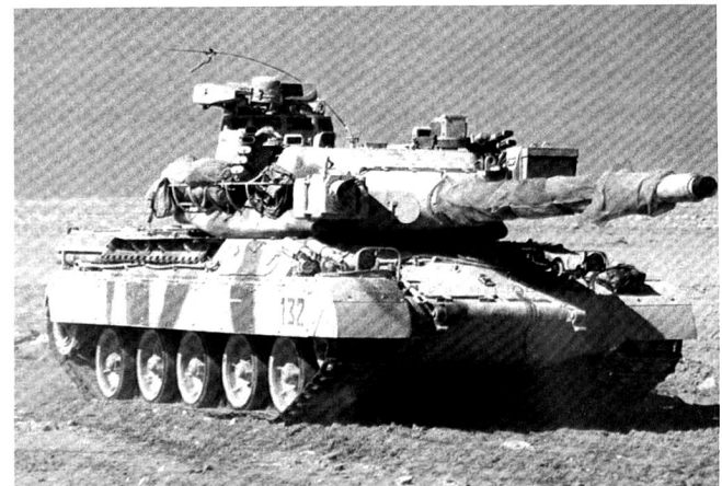
L'AMX30 emporte un canon de 10,5 cm, un canon de 20 mm et une mitrailleuse de 7,62 mm.
