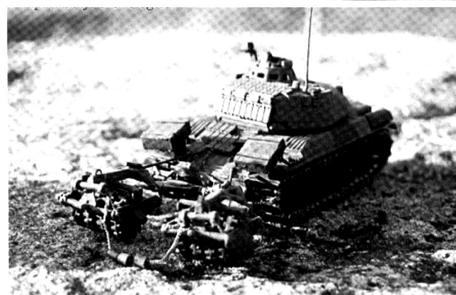
Ci-dessus : deux vues du système de déminage KMT-S, développé par GIAT à partir de l'AMX-30. Le système peut être téléopéré.
