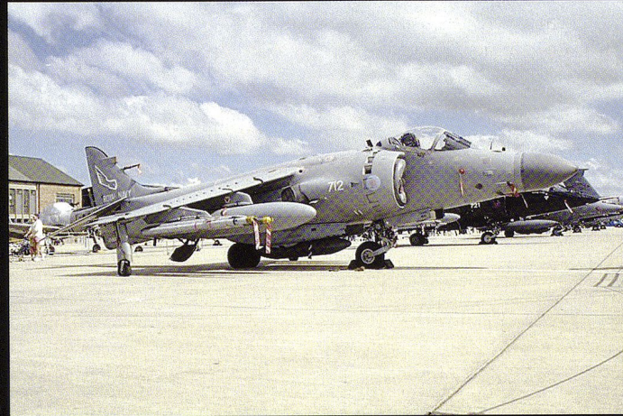
Le Sea Harrier F(A).2 dispose de capacités sensiblement augmentées, grâce à un nouveau radar et à la capacité d'emporter des missiles air-air à moyenne portée AMRAAM.
