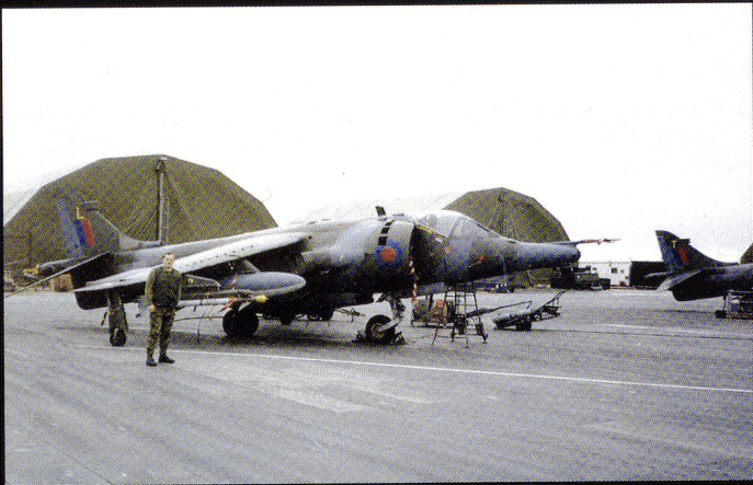
Un GR.3 du Sqn 1 déployé aux Falklands. Les premiers appareils opéraient à partir de l'île à partir d'une surface de plaques métalliques de quelques dizaines de mètres carrés.
