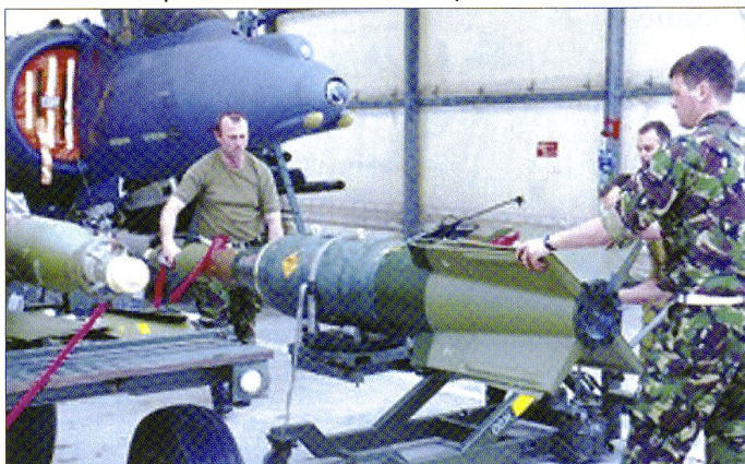
Les engagements au-dessus de l'ex-Yougoslavie ont connu une augmentation sensible du nombre de munitions de précision, à l'instar de ces bombes Paveway de 454 kg guidées par laser.
