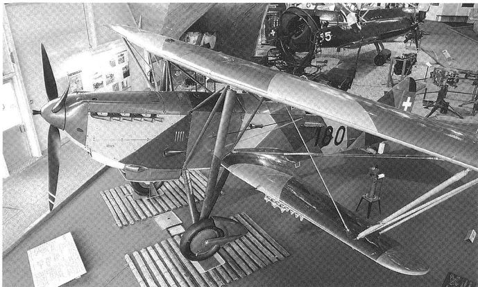
Le C-35, biplan développé en Suisse à partir du Fokker CV-E. Les illustrations proviennent du musée des Forces aériennes à Dübendorf.
