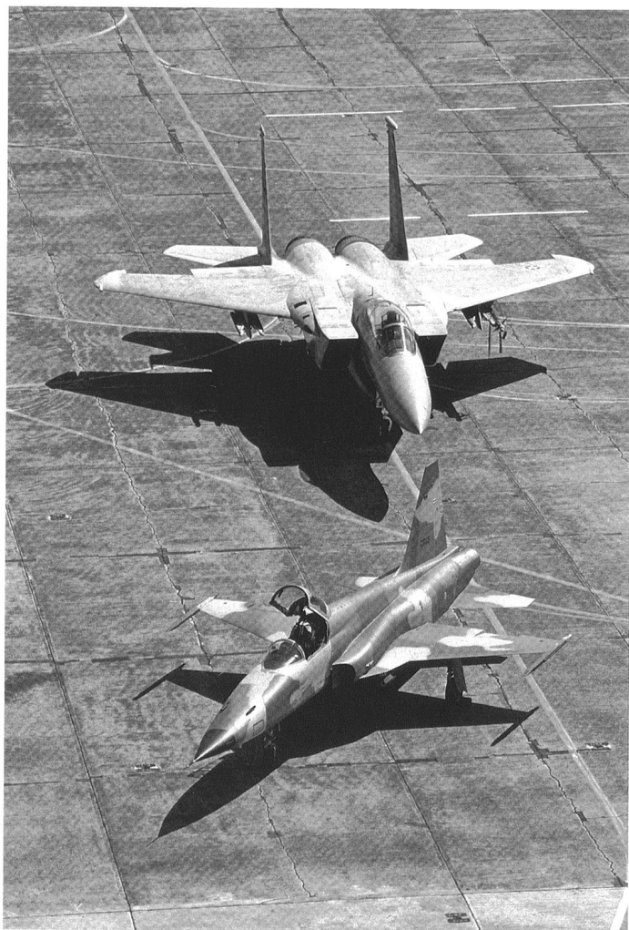
Comparé à un F-15, la petite taille du F-5E est bien visible. En combat rapproché, il est maniable et difficile à repérer.
