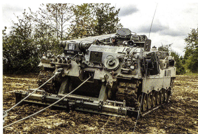
La grue du Büffel peut soulever 30 tonnes. Le treuil est en mesure de tracter jusqu'à 160 tonnes.
