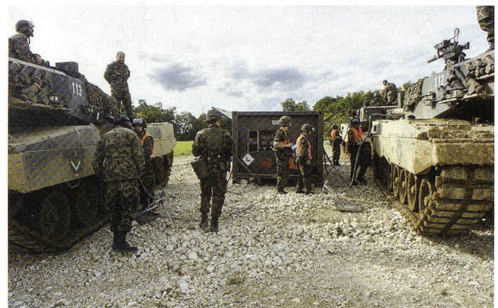
Les citernes BBC peuvent ravitailler simultanément 2 ou 4 véhicules en une dizaine de minutes.
