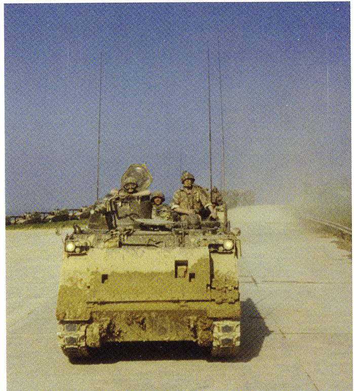
Durant près de 40 ans, la «monture» des grenadiers de char a été le M113 (char de grenadiers 63/73/89).
