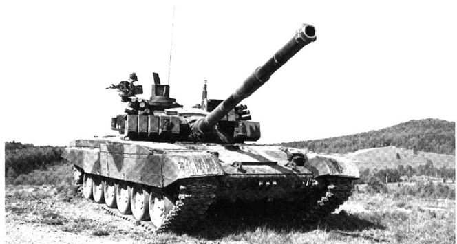
La République tchèque a modernisé ses T-72 avec une électronique occidentale, afin de tenter de les rendre compatibles avec l'OTAN.
