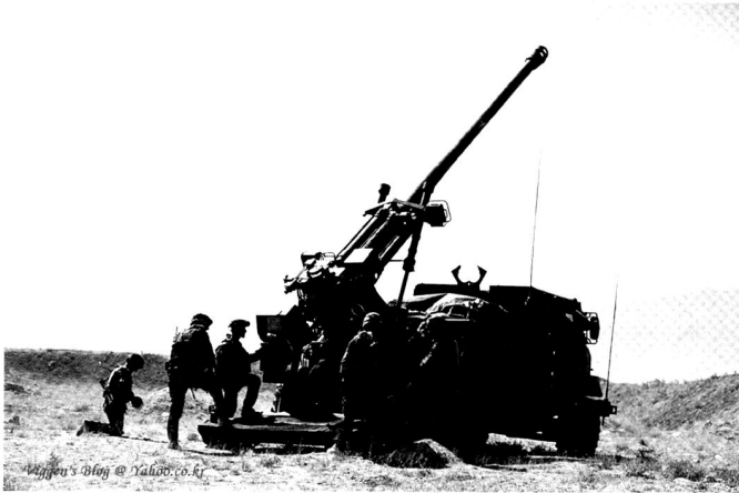
Les formations de manœuvre se sont « allégées » depuis la guerre froide, à l'instar de l'obusier autopropulsé César , 155 mm L52, qui peut être transporté par avion.
