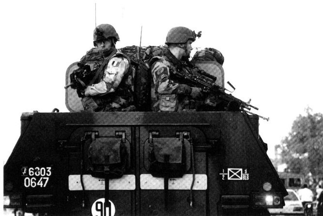
Le VAB, conçu par Renault, a bénéficié ces dernières années de plusieurs programmes de revalorisation et d'amélioration du degré de protection, le faisant passer de 10 à 14 tonnes.
