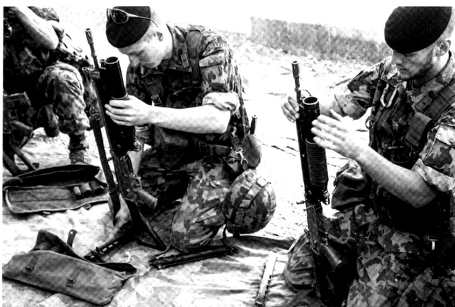
Instruction au montage et démontage du lance grenade additionnel sur le fusil d'assaut 90.
