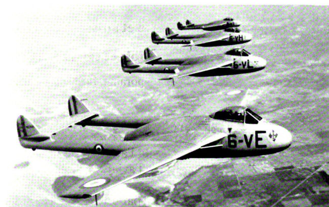
Le Vampire construit sous licence en France, dénommé SNCASE SE 535 Mistral , est reconnaissable à des entrées d'air simplifiées.
