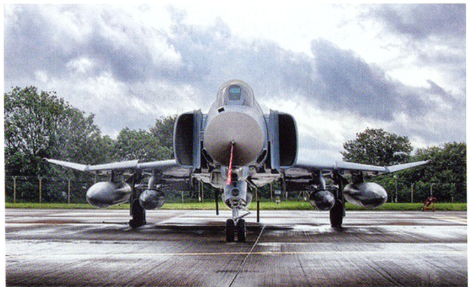
Présentation au sol du F-4F ICE. Celui-ci est armé d'un canon de 20 mm M-61 sous le nez et peut emporter jusqu'à 4 AIM-9 Sidewinder et 4 AIM-120 AMRAAM.
