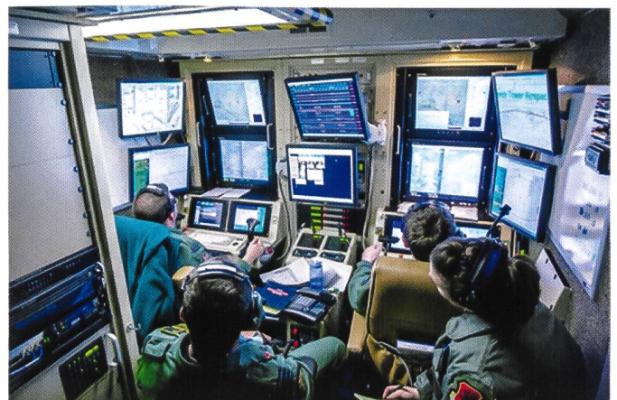
Station de contrôle d'un drone HALE ou MALE.
