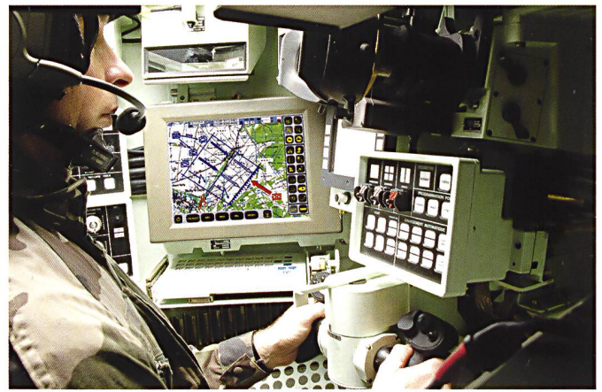
La place du commandant sur le char Leclerc T2 montre bien l'importance qu'ont pris les moyens d'observation et de communication. Le « système d'information terminal » (SIT) est le FINDERS de Nexter.
