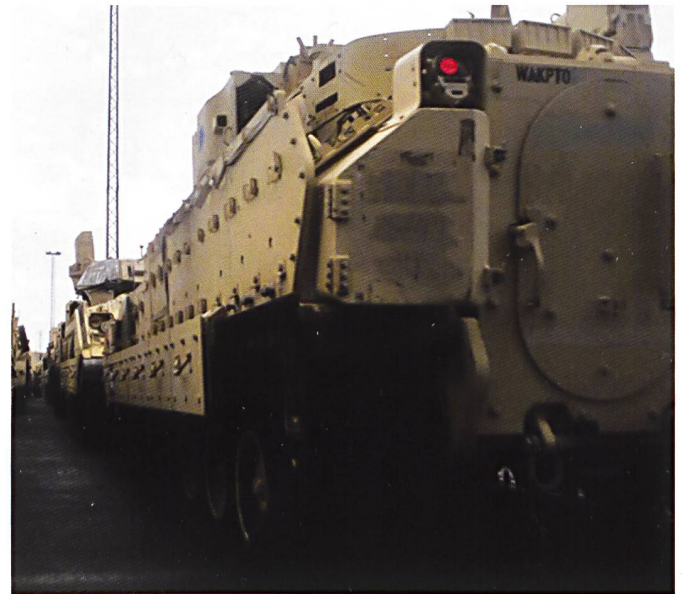
...et un nombre identique de M2A2 ou M2A3 Bradley. La version A3 est dotée d'une optique indépendante et stabilisée pour le commandant du véhicule (CIV) qui confère au véhicule des capacités de recherche et de combat proches du système de contrôle de tir de l'Abrams.
