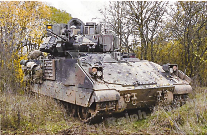
Le M3A2 est la version de reconnaissance du Bradley . Il dispose du même armement que le M2 de l'infanterie, mais emporte davantage de munitions et seulement deux explorateurs à l'arrière.
