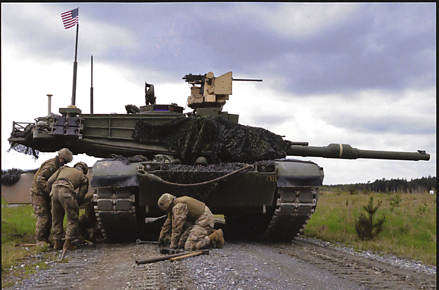
Ci-dessous : Un équipage américain à l'épreuve de maintenance, ici les travaux sur les chenilles.
