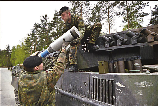
Un Léopard 2A6 allemand reçoit sa munition : ici un obus à charge creuse (MZ) d'exercice de 12 cm.
