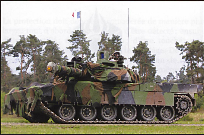
Le char Leclerc français pèse 56 tonnes et ne compte que trois membres d'équipages, car il dispose d'un système de chargement automatique du canon.
