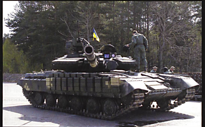
Une section de T64 ukrainiens prête à rouler. On remarque sur les flancs les caissons de munitions pour la mitrailleuse de 12,7 mm, les lance-pots nébulogènes et les briques de blindages réactifs (ERA).
