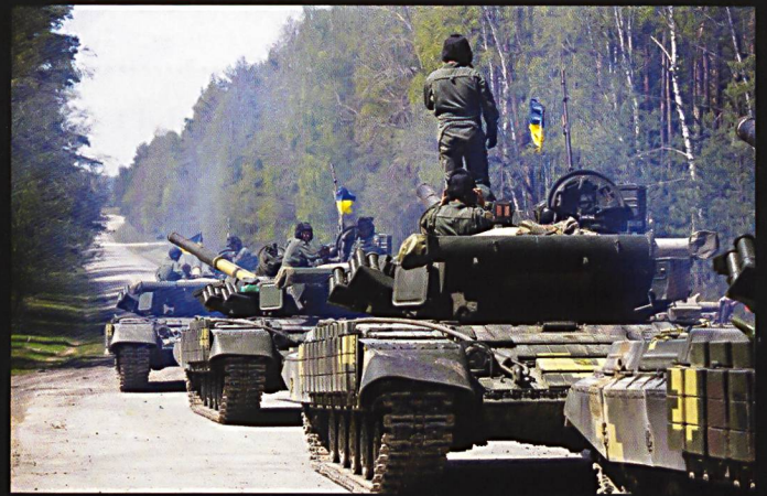
Une section de T64 ukrainiens prête à rouler. On remarque sur les flancs les caissons de munitions pour la mitrailleuse de 12,7 mm, les lance-pots nébulogènes et les briques de blindages réactifs (ERA).
