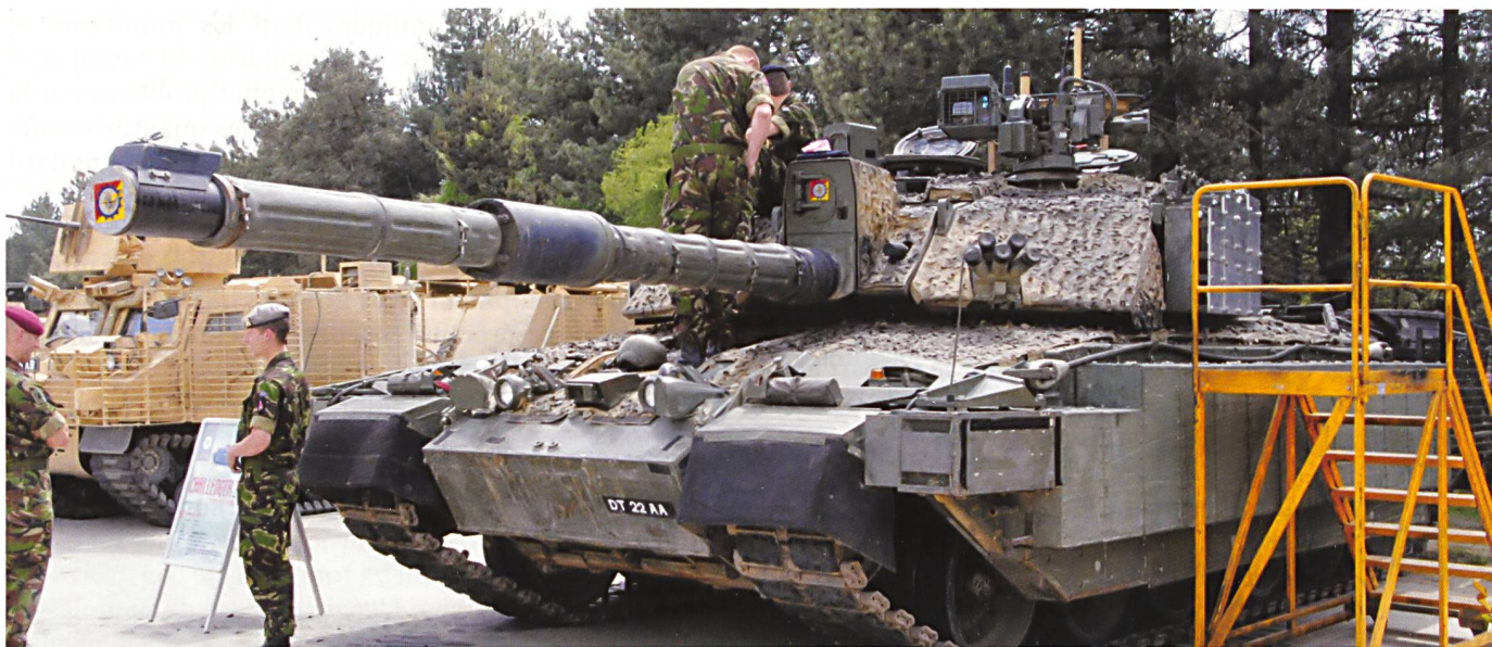
Deux vues du Challenger « Megatron, » dont les modules de blindage supplémentaires ont fait monter le poids à 73 tonnes.
