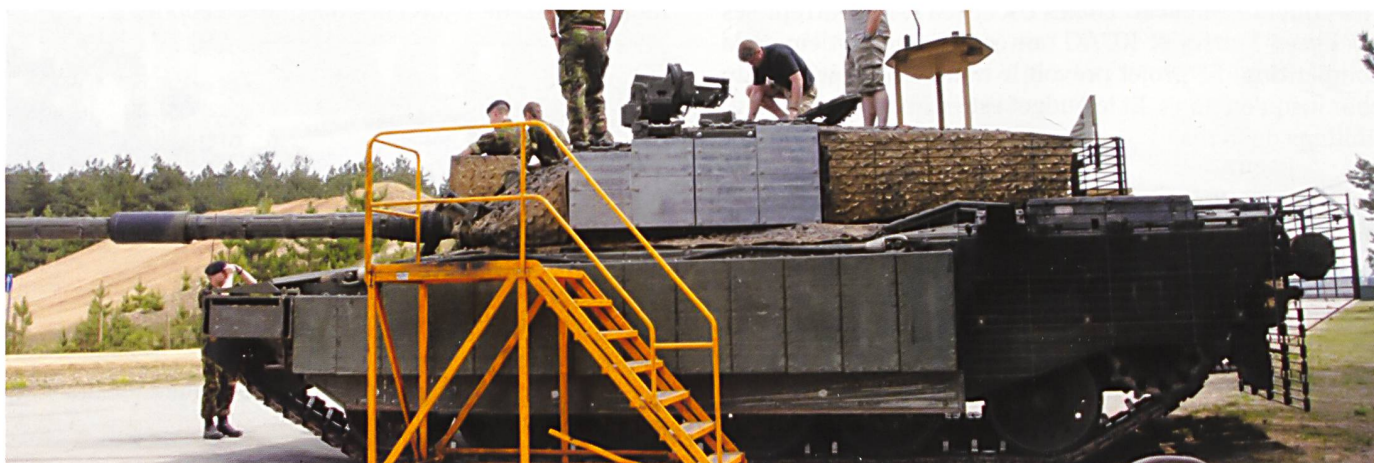
Deux vues du Challenger « Megatron, » dont les modules de blindage supplémentaires ont fait monter le poids à 73 tonnes.
