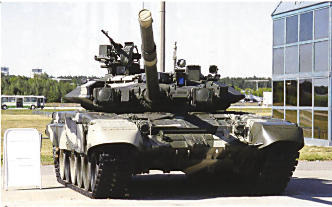
Le T90A est reconnaissable à ses blindages supplémentaires, ses brouilleurs de part et d'autre de la tourelle, ainsi qu'un affût de mitrailleuse pointant vers l'avant.
