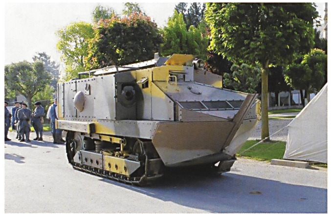
Le char Schneider CA1 pèse 13,6 tonnes et emporte une arme de 75 mm à canon court, ainsi que deux mitrailleuses
