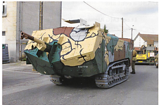
Le char Saint Chamond pèse entre 22 et 24 tonnes. Il est lourdement armé, car la Direction des services automobiles exigeait le montage d'un canon de campagne de 75 mm sur son affût depuis l'engin – ce qui ne pouvait évidemment qu'alourdir l'ensemble et le rendre impropre à la manœuvre.
