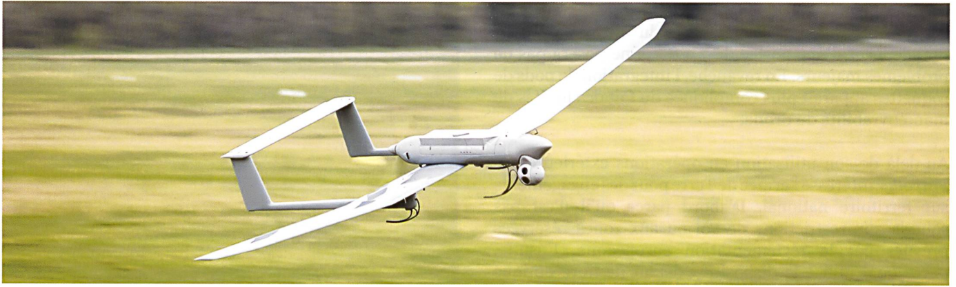
Le DVF-2000 à propulsion électrique de Survey Copter, filiale d'Airbus Defence & Space, testé par la Marine française. Lancé par catapulte, il est récupéré dans un filet.
