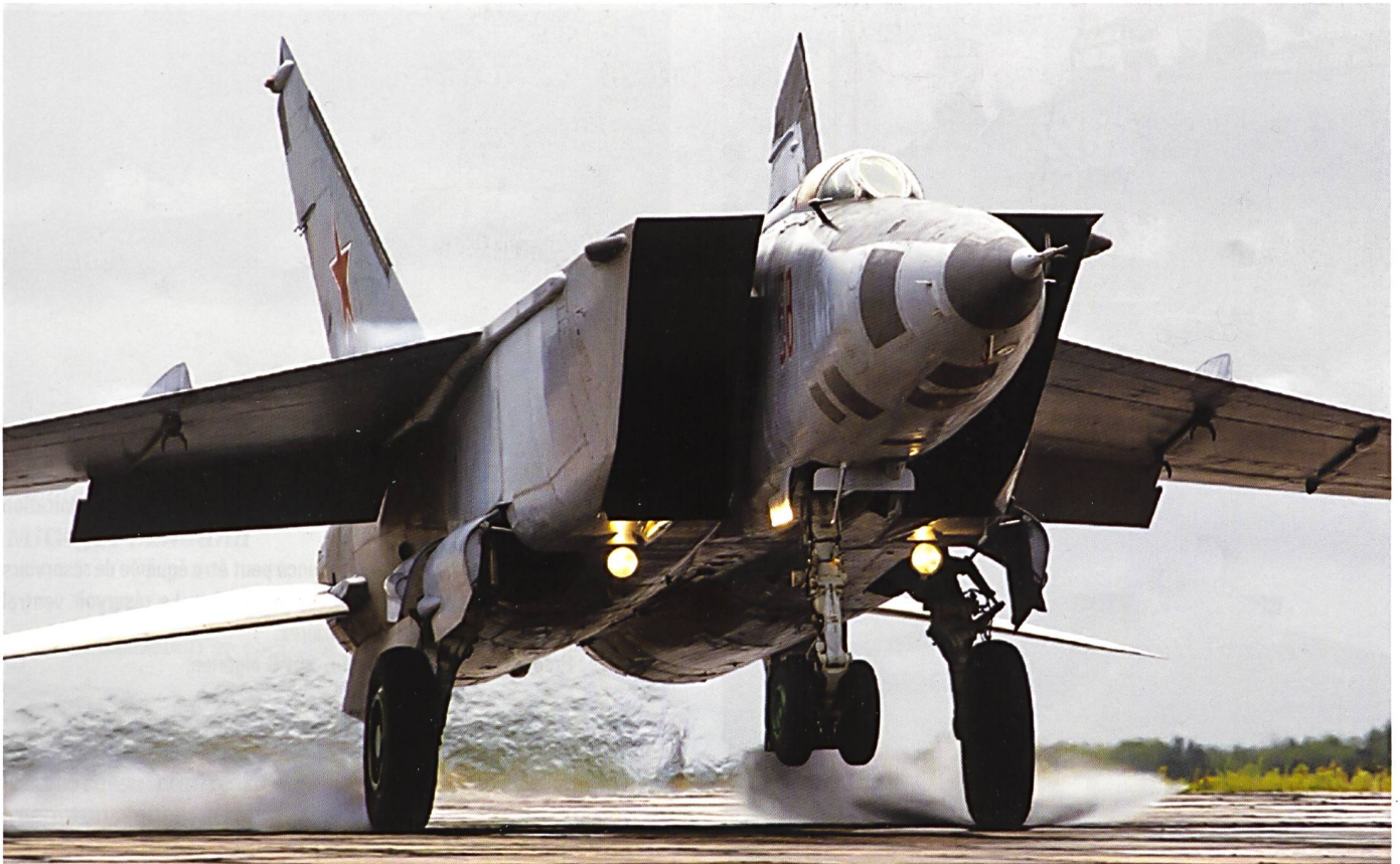
Ci-dessus : La version de reconnaissance du MiG-25RB, aux couleurs de la 2 e escadrille du 47 e régiment de reconnaissance de la Garde (GvORAP). Cette version pouvait emporter des bombes, qui auraient pu être larguées à haute altitude, à une distance de près de 40 km de leur cible. Ainsi larguées, ces dernières auraient été supersoniques en touchant le sol et auraient pu pénétrer 30-40 mètres de terre.
