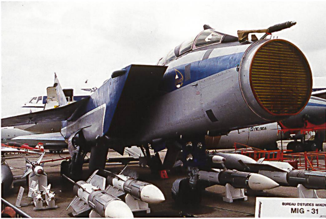
Vue du radar à balayage Zaslon-M , d'un diamètre de 1,40 m. Les armements présentés sont des AA-9 au centre et des AA-6 sous les ailes. Devant ces derniers sont présentés des AA-11 à courte portée.
