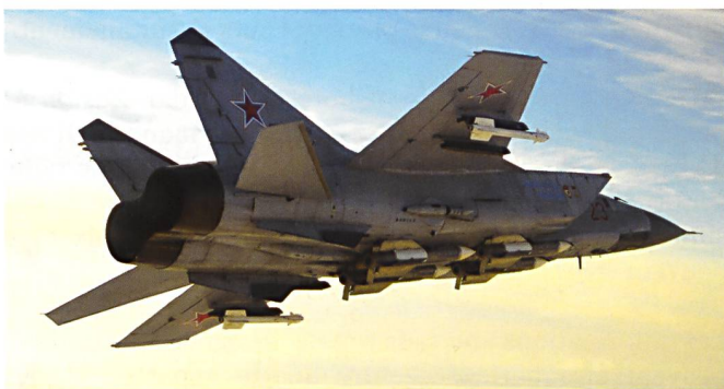
Ci-dessus : L'armement classique du MiG-31 se compose de quatre missiles à longue portée AA-9 et de deux missiles à courte portée AA-11. Le canon GSh-6-23 est visible à droite du fuselage.
