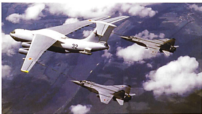
Comme son prédécesseur le MiG-25, le MiG-31 est destiné à l'interception à longue portée. Pour ceci, il dispose d'un radar performant et de transmissions de données radar et tactiques au sein du groupe et avec les radars aériens (A-50) ou terrestres. Contrairement à son ancêtre, il peut être ravitaillé en vol par l'Ii-76 ci-dessus.
