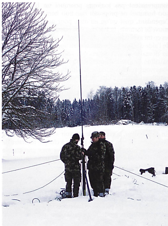
Ci-dessus : Installation d'antennes-relais VHF pour le réseau tactique SE-X35.
