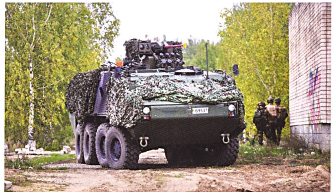
Le FUS est la version transport de troupes du Piranha III belge.
