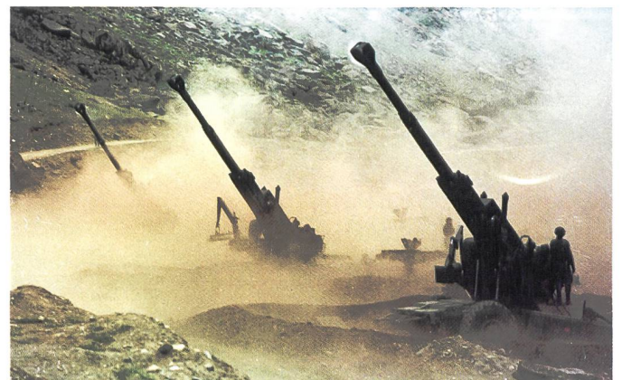
L'artillerie indienne est équipée depuis les années 1990 d'un grand nombre d'obusiers Bofors FH77 de 155 x 39 mm. Cette arme a une portée de 21 km ou 24 avec des projectiles assistés.
