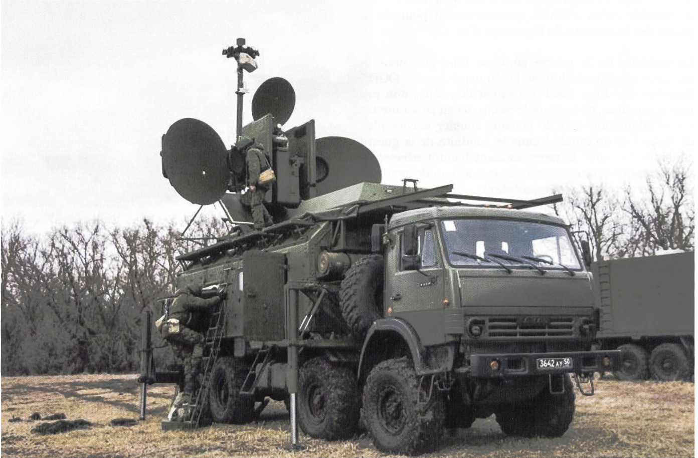
Le système russe Krasukha-4 permet de disputer la supériorité dans le spectre électromagnétique, vital pour toute opération aérienne.
